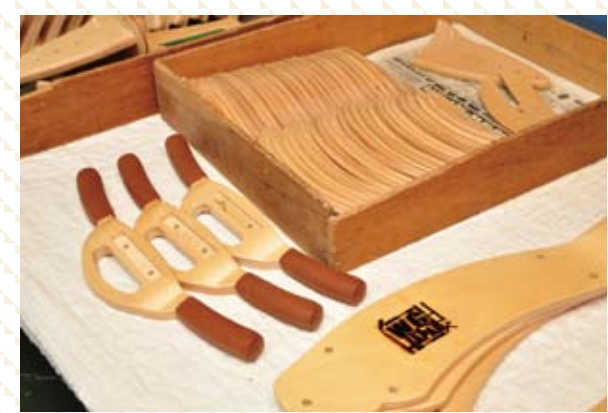
組み立てを待つ木製二輪玩具の部品たち。ハンドルの裏側は凹状に加工され、フォークと確実に固定する工夫が施されているのわかる。
